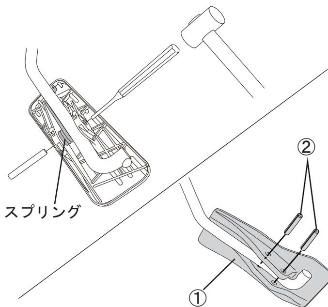
4. φ5のポンチを使用して純正アクセルペダルをアクセルロッドから取り外します。
