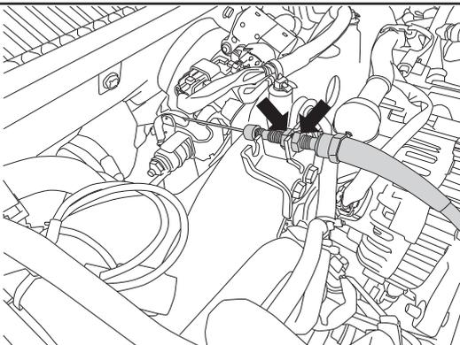
1. エンジンルームのアクセルケーブルのナットを緩め、アクセルワイヤホルダから取り外し、ワイヤーをスロットルリンクから取り外します。
