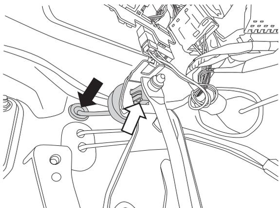
2. 黒矢印部のグロメットを外し、白矢印部をペンチ等で挟んでアクセルペダルブラケットから取り外し、アクセルワイヤをアクセルロッドから取り外します。
