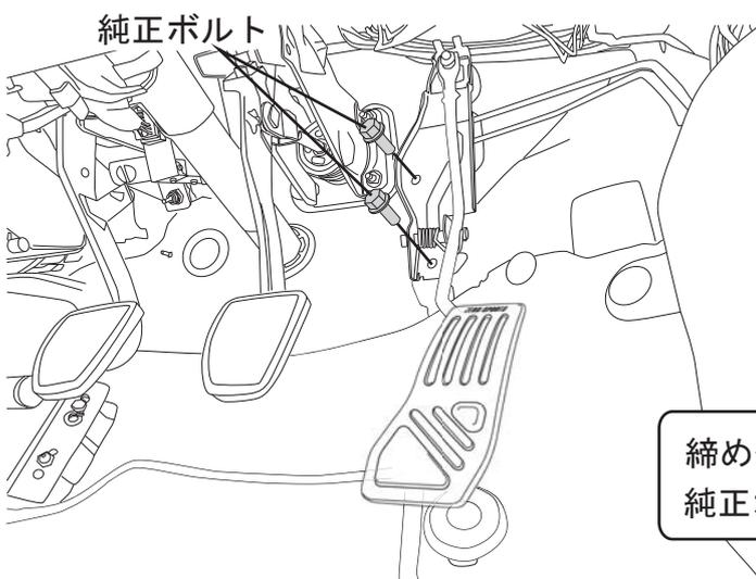
6. アクセルペダルアッセンブリを純正ボルトを使用して車体に取り付け、取り外した時と逆の手順でアクセルケーブルを取り付けます。
