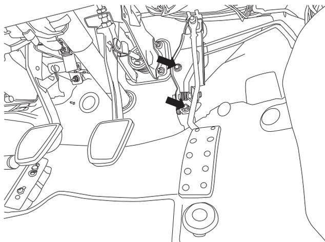
3. 矢印部のボルトを取り外し、アクセルペダルアッセンブリを取り外します。
