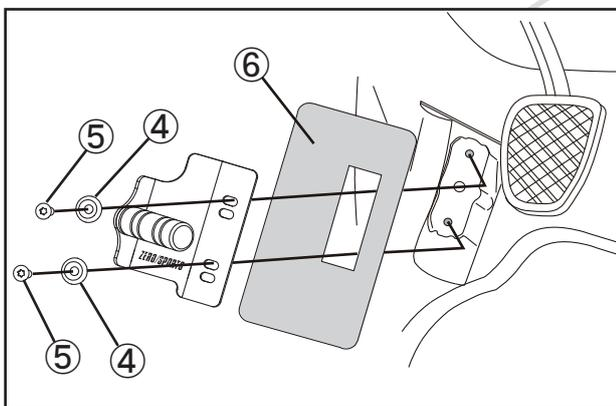
3. フットレストバーをカラー④、ボルト⑤を使用して車体に取り付けます。カーペット⑥をお好みの大きさにカットしてご使用ください。
