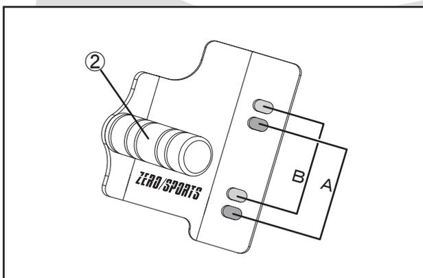
**☞ポイント** フットレストバーは、左図のようにA・Bの各箇所固定することで、高さ調整が可能です。
