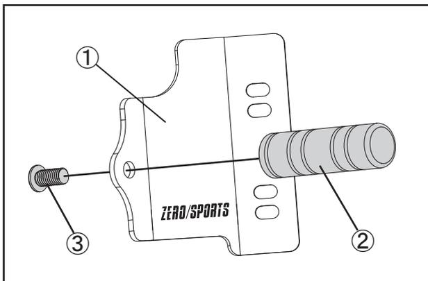
2. ブラケット①にボルト③を使用してフットバー②を取り付けます。
