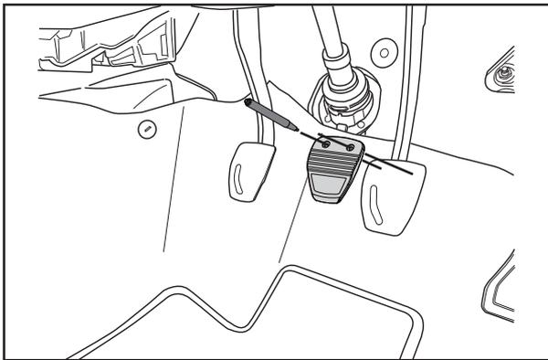
2. ブレーキペダル(クラッチペダル)に本商品のブレーキペダルを合わせ、穴位置2箇所をマジックなどでマーキングします。
