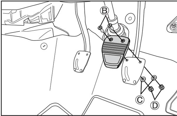
5. 本商品のブレーキペダル(クラッチペダル)をボルト⑧、ワッシャー⑨、ナット⑩で取り付けます。取り付け後は定期的にボルトに緩みがない事を確認し、緩みが確認された場合は増し締めを行ってください。
