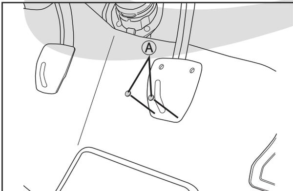
4. ブレーキペダル(クラッチペダル)に両面テープAを貼り付けます。
