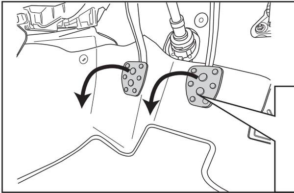
1. 純正のブレーキペダルパッド(クラッチペダルパッド)を取り外します。
