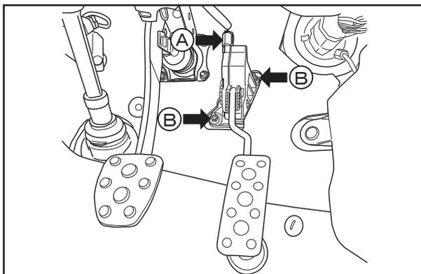
1. 車両バッテリーのマイナス端子を外し、アクセルレータに接続されているケーブル④を取り外します。
