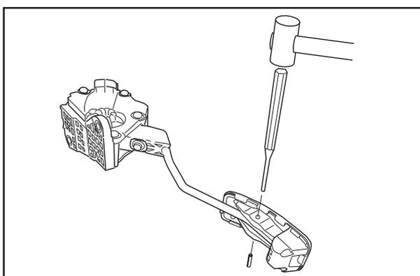
2. φ4のポンチを使用して純正アクセルペダルをアクセルレータペダルアセンブリから取り外します。
