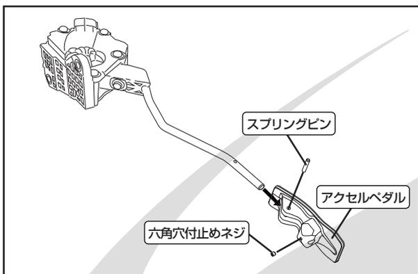
3. 付属のスプリングピンを使用してアクセルレータロッドに本商品のアクセルペダルを取り付けます。
