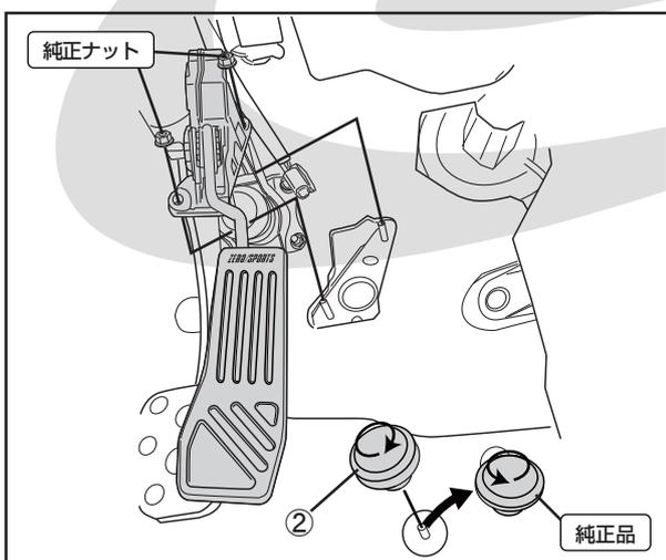
4. 純正ペダルストッパーを取り外し、付属の交換用ペダルストッパーに取り替えます。
