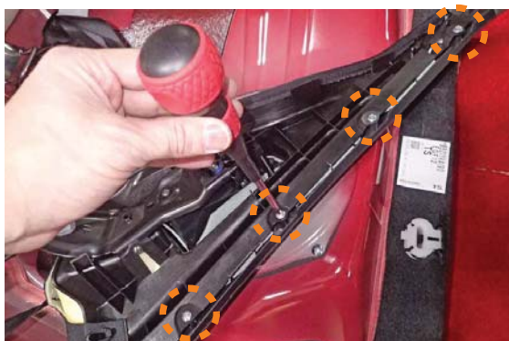
7 パーツ裏側のネジをプラスドライバーで外します。(計5か所)
