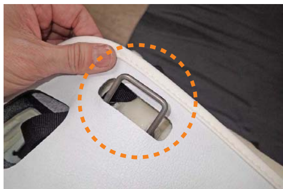
10 カバー後ろ側の加工穴から金属バーを取り出します。
