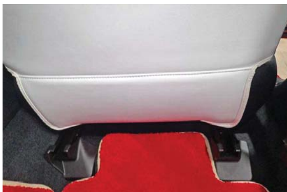
15 金属フックを座面裏の金属部分（任意の箇所）に引っ掛けて固定します。
