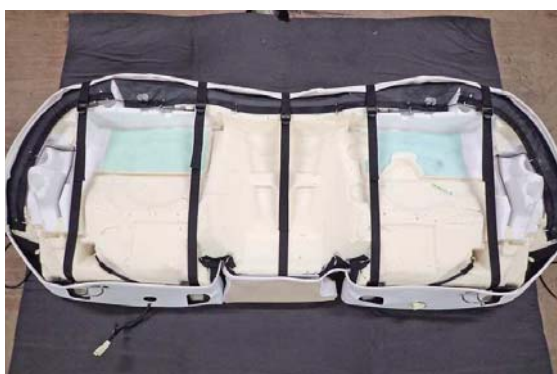
15 シートを裏返して、カバーに付いている5本のベルトを1列目座面と同様に固定します。
