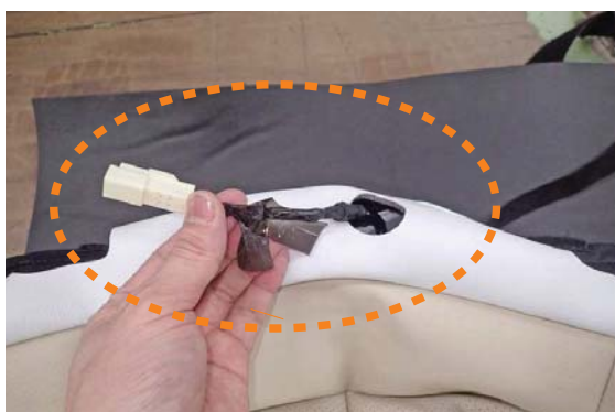
9 カバー後ろ側の加工穴から配線を取り出します。
