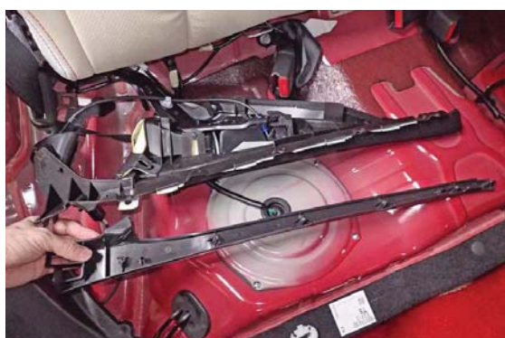
8 ネジを外すとプラスチックパーツが外れます。
