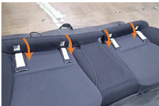
7 シートのチャイルドシート固定用加工穴を隠している生地のマジックテープを外します。(計4か所)
