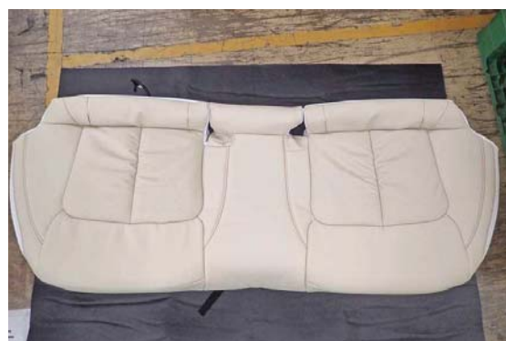
18 カバーのラインを整えて、2列目座面の完成です。 2列目背もたれ、アームレスト、サイドパーツのカバー装着後に車体へ戻します。
