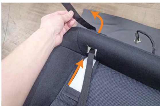
8 カバー裏に付いているベルトを加工穴に通します。(計4か所)
