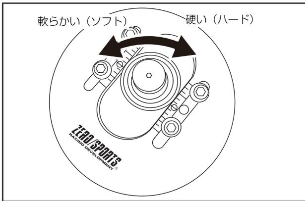
1. ロッド先端のダイヤルをハード方向に回し、締めきったところを基点「0」とし、ソフト側に回して最初にカチッとなったところが「1」となります。
