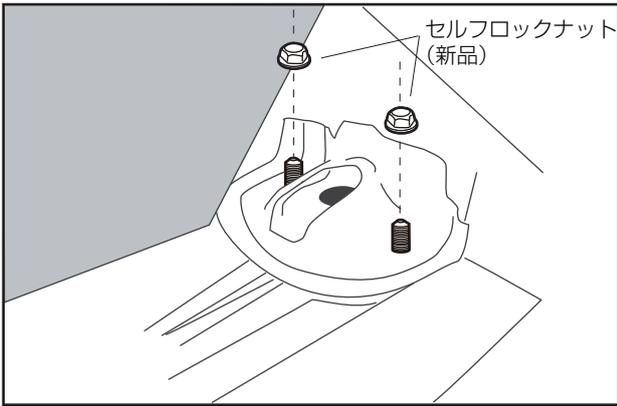
7. ウィニング RR リア側を車両側リアストラットマウント取付部に新品のセルフロックナットで仮止めします。
