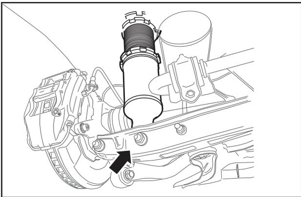
10. ハウジング結合部のボルトとナットを規定トルクで締め付けます。
