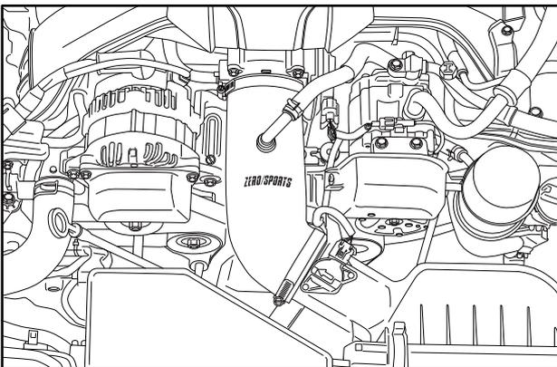
2. 付属のホースバンドを使用し、本体を取り付け、PVCホースとクランプを戻し、ホースバンドを締めて完成です。
