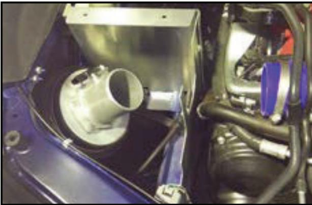
2. 遮熱板 A (インテークパイプ側) を取り付けた後、遮熱板 B (パワステアリングフルード側) を取り付けます。
