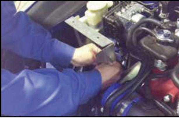
5. 各部をボルト、ナットで仮組みします。
