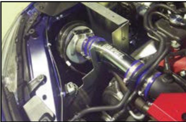
7. スーパーダイレクトフローを取り付けます。また、遮熱板の各部位のボルトを本締めします。
