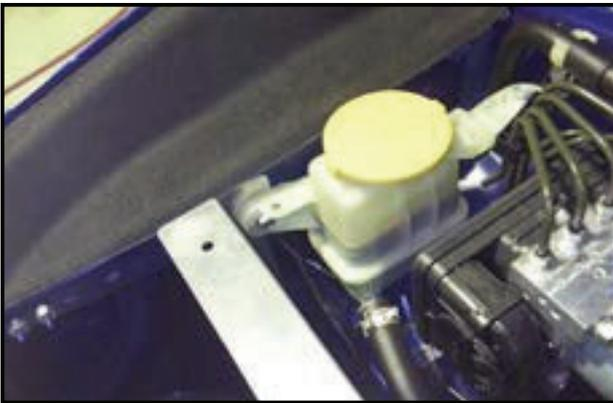
6. 写真のように遮熱板とパワステフルードタンク手前側のボルトを共締めします。
