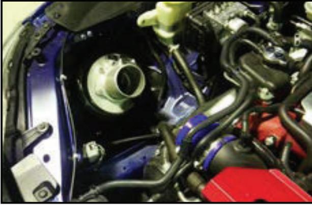
1. 純正インテークダクトを取り外し、クッションとクリップを再利用するために取り外します。スーパーダイレクトフローを外します。また、パワステフルードタンク手前側のボルトを外します。
