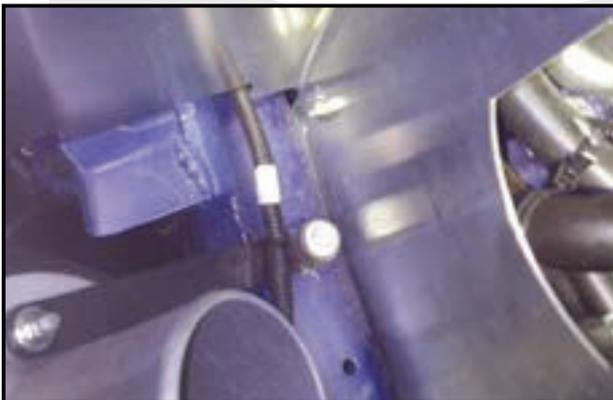
4. エアフロセンサーハーネスを写真のように、遮熱板とボディの間を通します。
