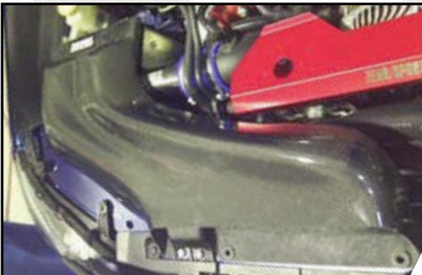
8. カーボンインテークダクトの取り付け位置に純正インテークダクトから取り外したクッションと付属のクッションを取り付けた後、クリップにて4箇所を固定して完成です。
