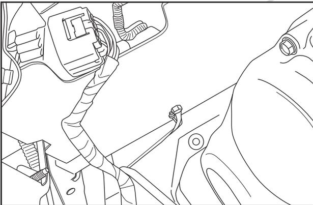
3. アース線と遮熱板を、イラストのように共締めします。
