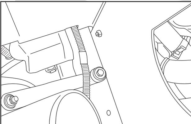
4. エアフロセンサーハーネスをイラストのように、遮熱板とボディの間に通します。
