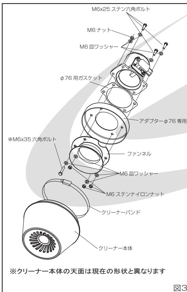
3. 図3を参考にエアフロアダプターパイプにファンネル、φ76用ガスケット、アダプターφ76専用、クリーナーバンド、クリーナー本体を組み付ける。
