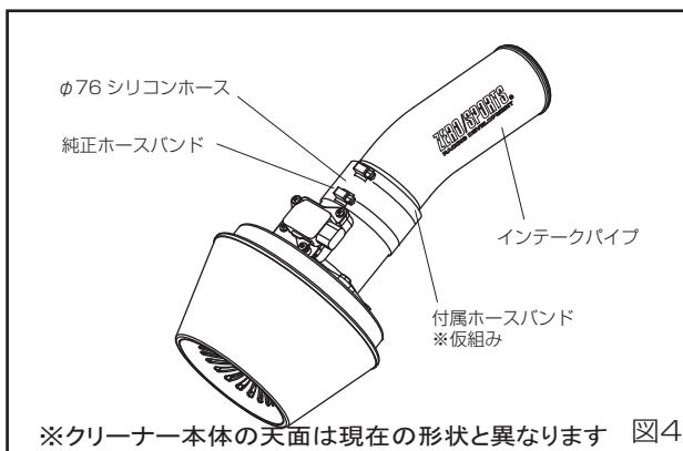
4. 3で組み付けたダイレクトフロー先端部ヘインテークパイプを付属のφ76シリコンホース、ホースバンド、純正ホースバンドを使い組み付ける。(図4)
