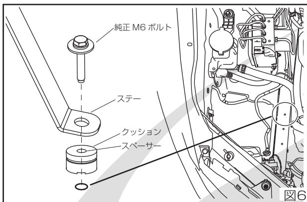
6. 付属ステーを1で取外したクッション、スペーサー、純正M6ボルトを使い、仮組みしておく。(図6)
