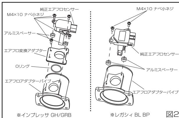
2. 図2を参考に純正エアフロセンサーのタイプに合わせてエアフロアダプターパイプへ組み付ける。
