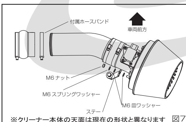
7. 4で組み付けたダイレクトフローとクッションホース、ステーを組み付ける。(図7)
