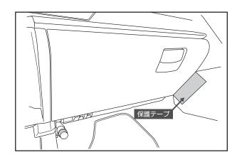
グローブボックスとセンターコンソール面がこすれて傷がつかないように、センターコンソール面に保護テープを貼ります。
