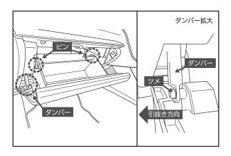
2. グローブボックスを開き、ダンパーをツメから引抜くように外します。両側面板を内側に曲げてピンの引っかかりを通過させグローブボックスを開放させます。
