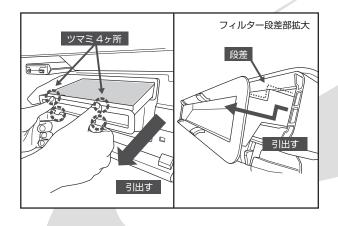
3. グローブボックスを開放した奥にあるフィルターの ツマミ 4ヶ所を上下に押しながら、古いフィルター を引出します。フィルターに段差があるため、フィルターをまっすぐ 1 cm ほど引出してから下に傾け て引出します。
