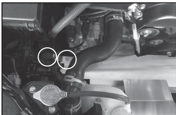
5. 左図の通りにヒューズボックスステー下に挟み込み、純正固定ボルトを使用して、ステー（短いストレートタイプ）を仮止めしておいてください。また、クールインシュレーター本体とステーを付属のボルトにて固定してください。
