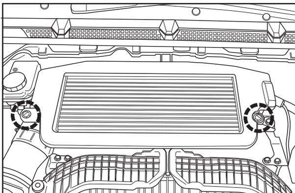
6. 図の○印のクリップ2か所を外し、奥側両サイドを真上に持ち上げるように純正インタークーラーカバーを取り外します。
