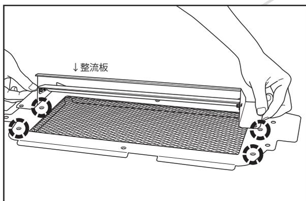
3. 「ベースプレート」に「整流板」を前方4か所の○印が合うようにのせます。
