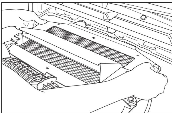
10. 左右の純正グロメットを奥の車両側に差し込むようにして、9で組み付けた本体を取り付けます。
