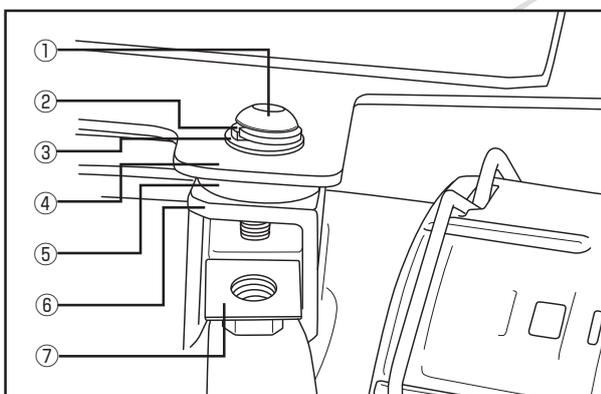
12. カラーをベースパネルと車両側の間に挟み、六角穴付きボタンボルトにスプリングワッシャー、平ワッシャーを通して、ナットプレートを使用して仮留めします。
