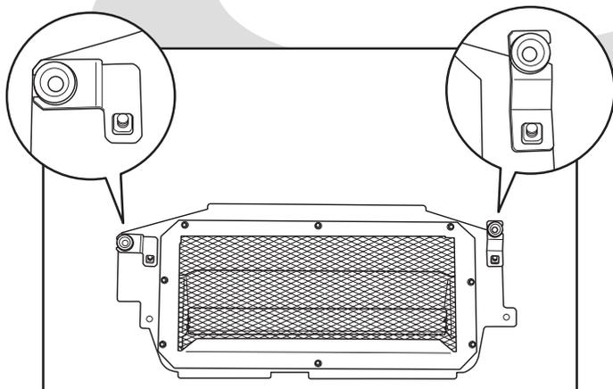
9. 組み付けが完了した本体のベースパネル裏面に、純正グロメットを装着したステー①とステー②を、図の向きになるように六角穴付ボタンボルト、スプリングワッシャー、平ワッシャーを使用して仮留めします。
