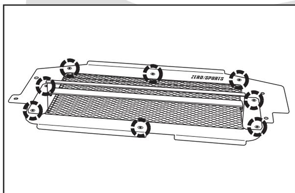
4. 8か所の○印を、皿ネジとロックナットで仮固定します。
