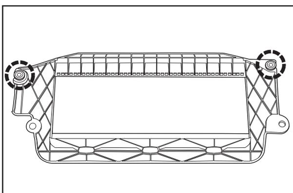
7. 純正インタークーラーカバー○印の左右2か所の純正グロメットを外します。
