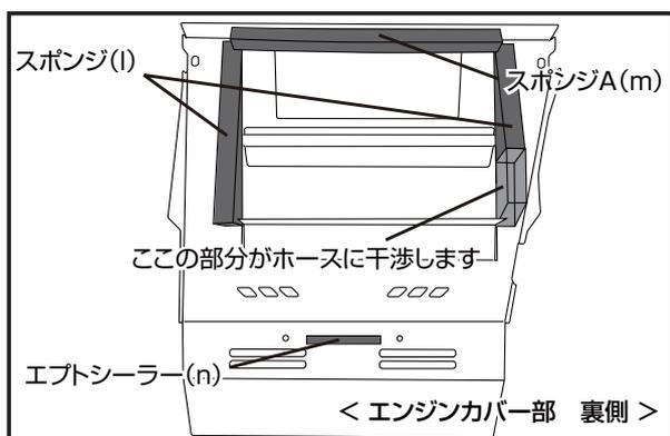
9. エンジンカバー部 (k) に左図のようにスポンジ (l) とスポンジ A (m) ・エプトシーラー (n) を貼り付けてください。
