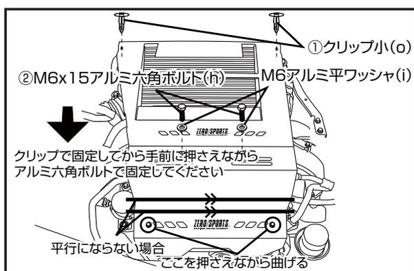
10. エンジンカバー部 (k) を上部をクリップ小 (o) で固定し、手前に抑えるようにしながら左図のようにボルト (h) とワッシャ (i) で固定して完成です。
