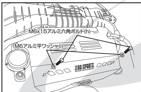
7. ベルトプロテクター ( g ) を左図のようにボルト ( h ) ・ワッシャ ( i ) で固定してください。
