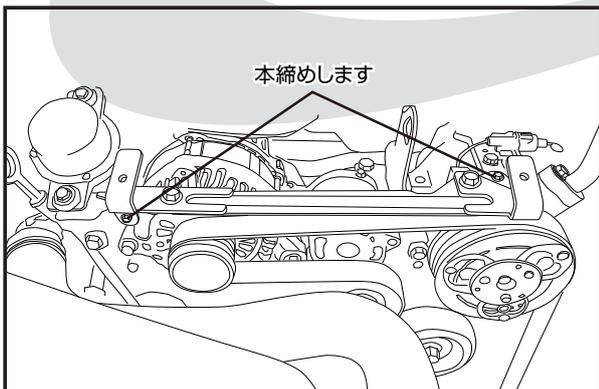
4. ステー (d,e) を仮止めした状態で、エンジンカバーステー (b) を取り付けます。
