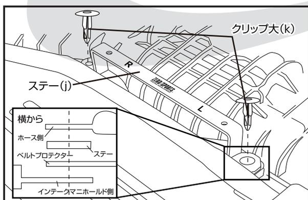
8. エンジンカバー部用のステー ( j ) を、左図のようにベルトプロテクターとホースの間に挟み、クリップ大 ( k ) で固定してください。
