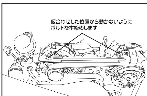
6. ベルトプロテクター ( g ) の仮合わせが完了したら、一旦ベルトプロテクターを外し、ステー ( d, e ) を固定してください。
