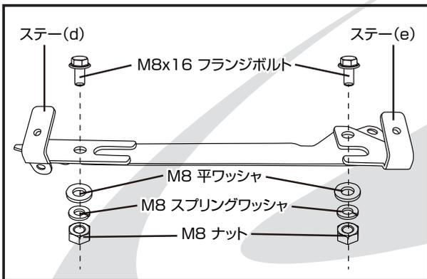
3. エンジンカバーステー (b) に付属のステー (d,e) を左図のようにボルト・ワッシャ・スプリングワッシャ・ナットにて仮止めします。
