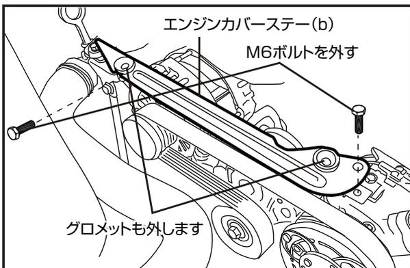
2. エンジンカバーのステー (b) を取り外した後、取付部のグロメット (ゴム部品) (c) も取り外します。
