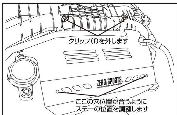
5. クリップ ( f ) を外し、ベルトプロテクター ( g ) の仮合わせをします。
