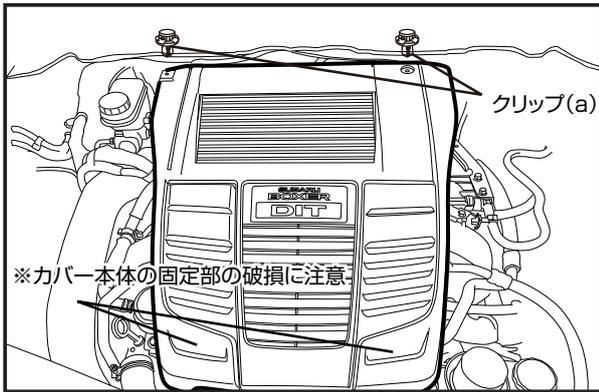
1. エンジンカバー上部のクリップ (a) を外し、純正エンジンカバーを取り外します。
