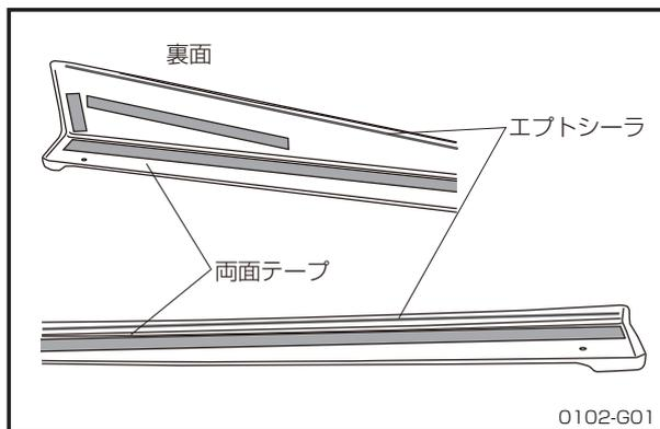
1. サイドステップ裏側（ボディとの接触面）に付属の両面テープ、エプトシーラを貼り付けます。
