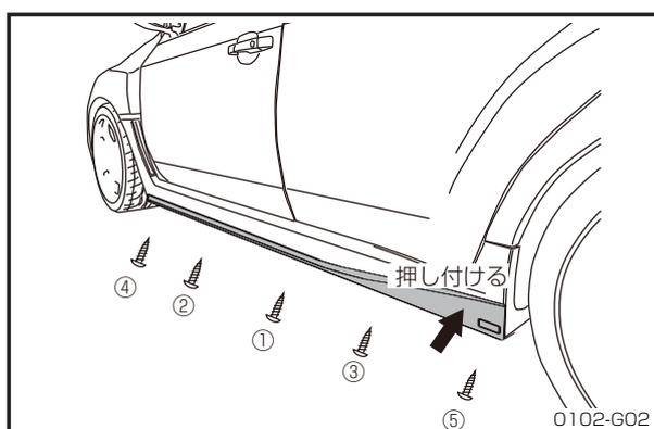
2. 純正サイドステップを脱脂した後、再度ステップをボディに両面テープを使って仮止めし、付属のM4x16タッピングスクリューを使って固定します。
